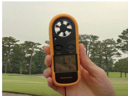
写真 4.2 照度計(左)、温度も測定できる風速計(右)
