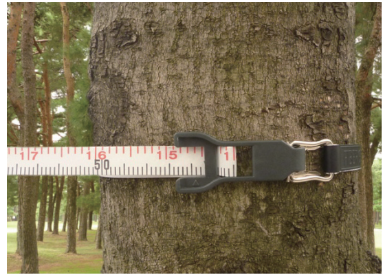
写真 6.2 胸高直径の測定は直径巻き尺が便利
