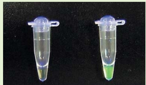
マツ材線虫病診断キット、右が発色しセンチュウ検出を示す
